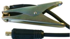
Massekabel komplett, Gummi, 35 mm<sup>2</sup>. Stecker 35-50 mm<sup>2</sup>, Klemme 300 A. 5 m lang.
