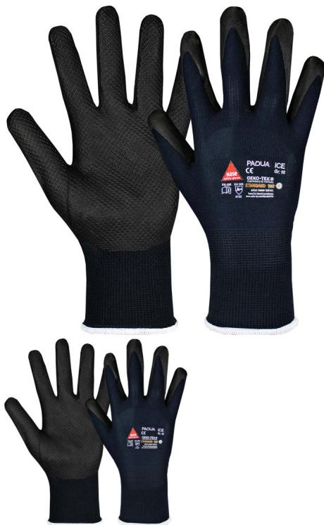
Montagehandschuh mit hohem Tragekomfort Länge = 25cm Material : 1,0 mm Nylon-Gewebe (100%) Handinnenfläche und Fingerkuppen sind mit Foam. Nitril-Beschichtung und Diamond Grip, schadstoffgeprüft. Verwendungsbereiche : Elektroindustrie, Automobilindustrie, Präzisionsarbeiten, Verpackung Größe : 7 - 11
