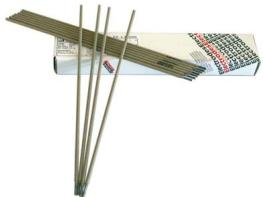
Rutilumhüllte Elektrode insbesondere für Verbindungsschweißungen und Kehlnähte in Position PA und PB.
