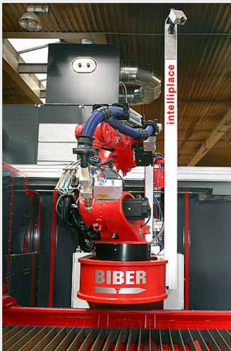
1. Am Schneidroboter angebautes Kamerasystem erfasst Tischbelegung
