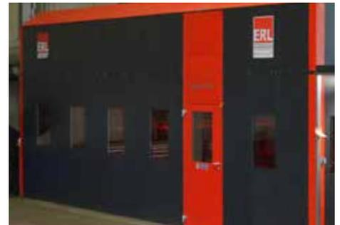
Die gesamte Anlage ist von einem Schutzzaun umgeben. Bei Bedarf kann der Schneidbereich auch komplett eingehaust werden.
