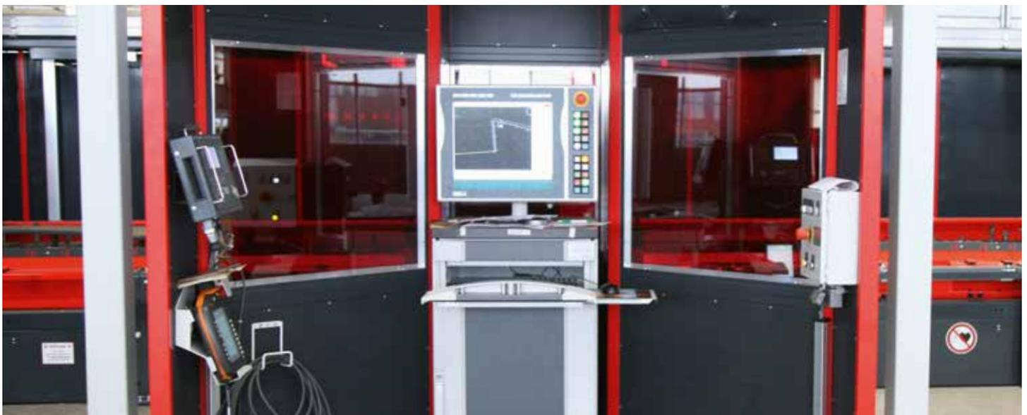
Die Bedieneinheit steht zum Schutz des Anlagenführers im Sicherheitsbereich, durch Fenster mit Blendschutz ist der Schneidbereich dennoch jederzeit gut einsehbar.
