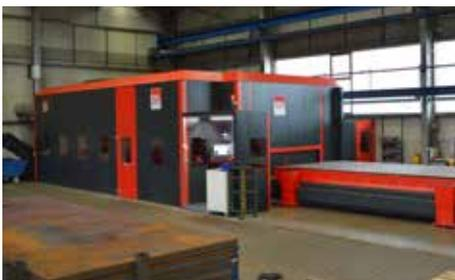
Schallschutzeinhausungen reduzieren die Lärmbelastung am Arbeitsplatz.
