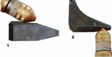
Beispiel: In Bild 1 beträgt die Fasenlänge 80 mm. Durch die maximale Schneidlänge beim Plasmaprozess von ca. 50 mm ist die Faser in der hier dargestellten Standardeinstellung nicht mit Plasma schneidbar. Dank der Teachfunktion wird die Faser quer zur Standardeinstellung (Bild 2) geschnitten, da es sich hierbei um eine Fasenlänge von 10 bis 20 mm handelt - also mit Plasma problemlos realisierbar.
