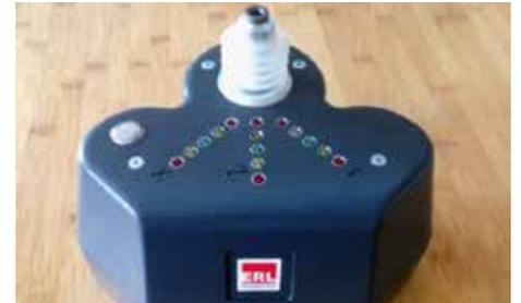
Mit der TCP Vermessungseinheit kann eine konstant hohe Schneidqualität sichergestellt werden.
