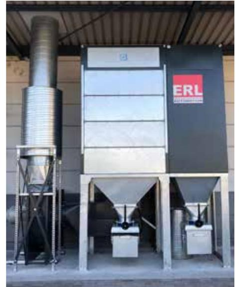
Optional können 200 l Fässer oder 1.000 l Big Bag Säcke verwendet werden. Für Letztere wird in der automatisierten Lösung eine Zellradschleuse verbaut, damit der Unterdruck in der Absauganlage den Big Bag nicht einsaugt.
