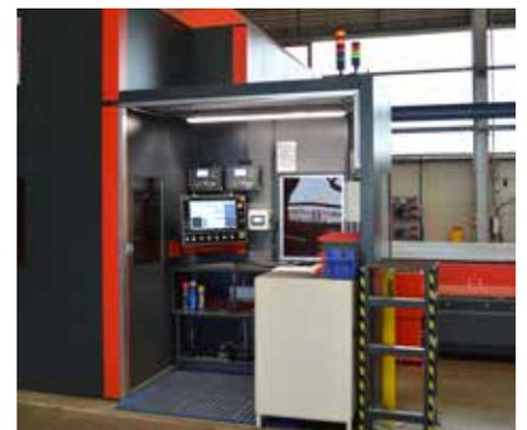
Zum Schutz der Bediener vor Lärmemissionen kann die Steuerung auch in einer schallgedämmten Kabine untergebracht werden.
