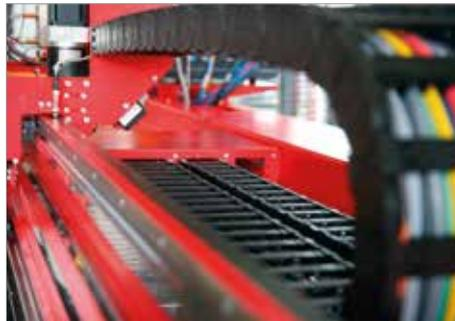
Sichere Medienführung: Durch die Sandwich-Bauweise sind Schläuche und Kabel geschützt.
