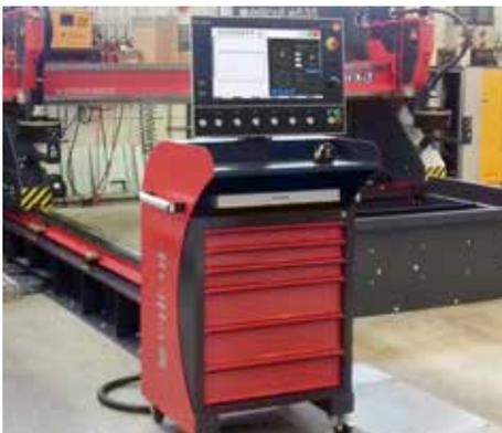
Das freistehende Bedienpult ist in der näheren Umgebung der Anlage verfahrbar.
