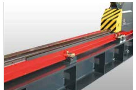
Durch Einsatz eines Mehrfachabstreifers reinigen sich Laufräder und Laufbahn selbst.
