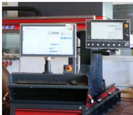
Bei der Twin-Panel Ausführung steht sowohl ein fest am Portal montierter als auch ein mobiler Monitor als vollwertige Steuerung zur Verfügung.
