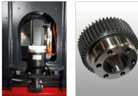
Die Kraftübertragung in x- und y-Richtung erfolgt über präzise Zahnstangen und Ritzel.
