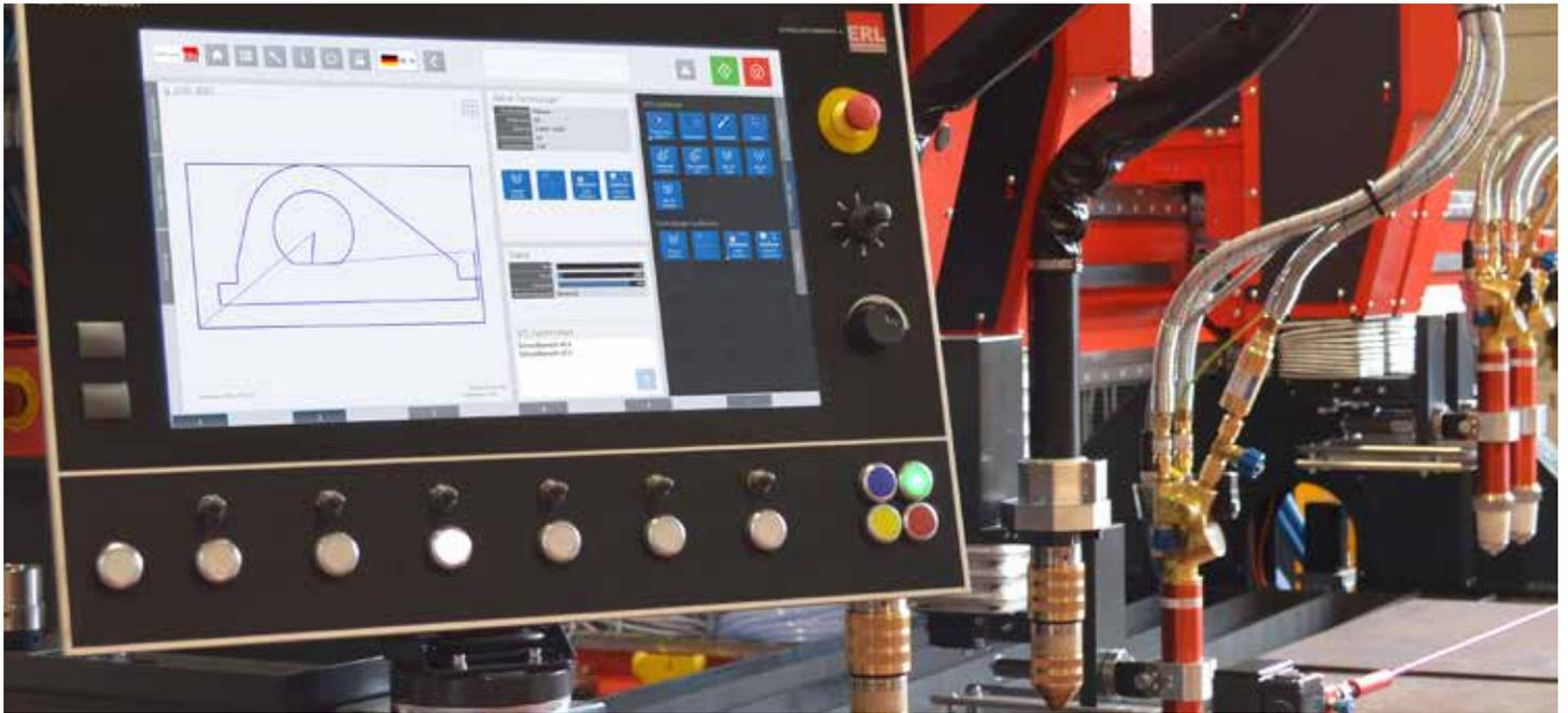
Die e\*volution Steuerung ist eine netzwerkfähige Touchscreen-Steuerung für alle thermischen Schneidprozesse wie Autogen- und Plasma-Schneiden sowie Markiergeräte und Bohrsysteme.
