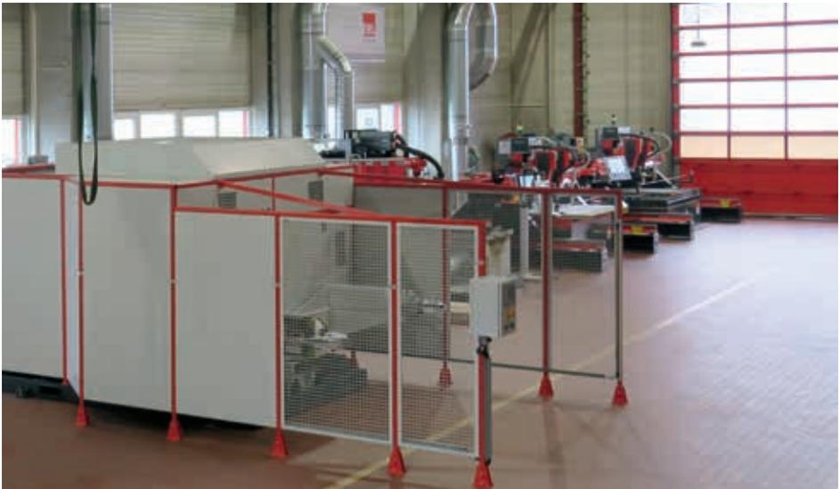
*Im Vordergrund: Roboterschweißanlage, im Hintergrund: 2 ercut Schneidanlagen*
