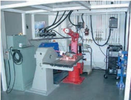
Um mehr Erfahrung mit Robotersystemen zu sammeln wurde das Technologiezentrum ursprünglich mit einem gebrauchten Motoman Industrieroboter vom Typ L106 und der Steuerung YASNAC RX ausgestattet. Um Bauteile aufspannen zu können wurde zusätzlich ein Kipptisch montiert. Von Abicor Binzel erhielt das Technologiezentrum eine
