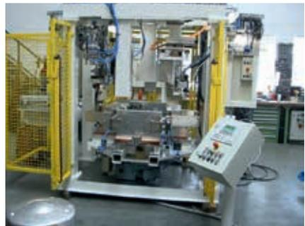
Installiert haben wir einen Automaten mit 4 Stationen. In drei Arbeitsstationen werden gleichzeitig die beiden Röhren, die beiden M4 Gewindebolzen und die 4 M3 Gewindebolzen eingeschweißt. Parallel werden in der Einlegstation die fertigen Behälter entnommen und ein ungeschweißter Behälter eingelegt. Mit einer Taktzeit von ca. 30 Sekunden haben wir die Vorgaben des Kunden erfüllt.
