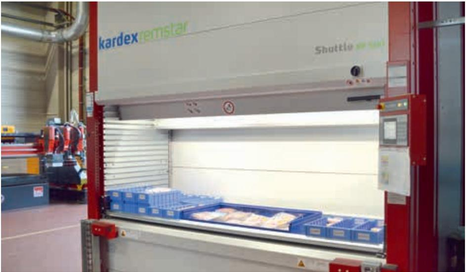
*Shuttle-Lagersystem für Verschleiß- und Maschinenteile*
