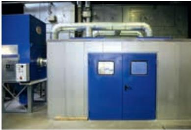
Die Kabine ist für 2 Arbeitsplätze ausgelegt und hat zwei Rückwandabsaugwände für Schleifarbeiten und zwei Deckenabsaugeinrichtungen für Schweißarbeiten an jedem Arbeitsplatz.
