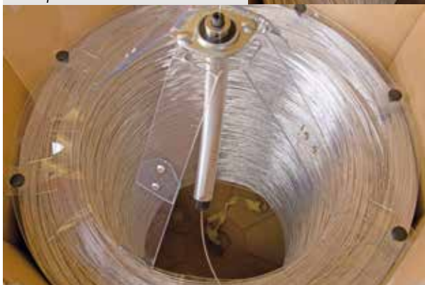
3. Jumbo-Fass mit eingesetzter Abspulhilfe
