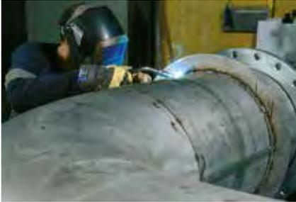
Die Hauptaufgaben des Schutzgases bestehen darin, den Schweißbereich während des Schweißvorgangs vor atmosphärischen Einflüssen, also vor Oxidation und Stickstoffnahme, zu schützen und den Lichtbogen zu stabilisieren. Die Auswahl des Schutzgases kann einen Einfluss auf die Eigenschaften des Lichtbogens haben.
