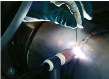
Ein perfektes Schweißgut ohne Beeinträchtigung der Korrosionsbeständigkeit und mechanischen Eigenschaften kann nur erzielt werden, wenn ein Wurzelschutz angewendet wird, der zu sehr niedrigen Sauerstoffgehalten führt.
