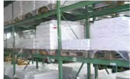
Augenscheinlich beschädigte oder nass gewordene Verpackungen von Schweißzusätzen dürfen erst nach einer Freigabe durch eine qualifizierte Person (Hersteller, Schweißaufsicht) verwendet werden. Eine Trocknung von nass gewordenen Schweißdrähten oder -stäben ist grundsätzlich nicht möglich.
