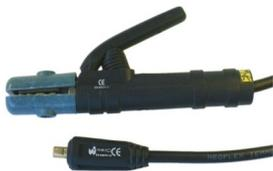
Elektrodenhalterkabel komplett, Gummi, 16 mm<sup>2</sup>. Stecker 10-25 mm<sup>2</sup>, Elektrodenhalter 200 A. 5 m lang.
