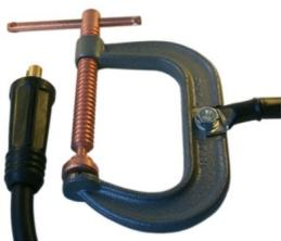
Massekabel komplett, Gummi, 95 mm<sup>2</sup>. Stecker 70-95 mm<sup>2</sup>, Zwinge 800 A. 5 m lang.
