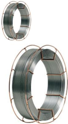
UP-Drahtelektrode zum Schweißen stabilisierter und nichtstabilisierter, nichtrostender Cr-Ni-Stähle, z. B. 1.4301, 1.4306, 1.4541, 1.4550, für Betriebstemperaturen bis 350° C.
